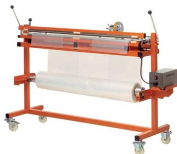
Per la produzione di sacchi da bobina, il materiale viene tirato manualmente per la lunghezza desiderata; il contametri applicato dietro alle ganasce saldanti consente di visualizzare la lunghezza, evitando così di dover avere un lungo tavolo di appoggio per il film.
